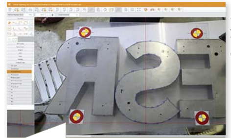
Mit der VirtualDigitizing Software lassen sich Schablonen, Muster und 2D-Objekte für Modellscheiben schnell und einfach digitalisieren.
