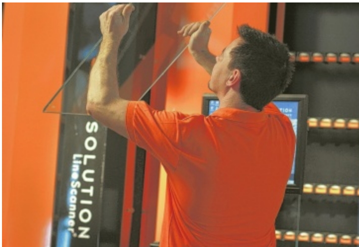
Der innovative Linescanner zur Qualitätsprüfung von Glas
